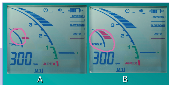
Abb. 5: Bild A: Das aktuell gemessene Drehmoment (obere Markierung) ist gering und noch weit vom eingestellten Maximalwert (untere Markierung) entfernt Bild B: Je größer das Drehmoment ist, desto mehr Markierungsstriche werden dargestellt. Erreicht die Belastung der Feile das maximale Drehmoment, stoppt sie automatisch oder schaltet in den Rückwärtsgang – je nach Wunsch
