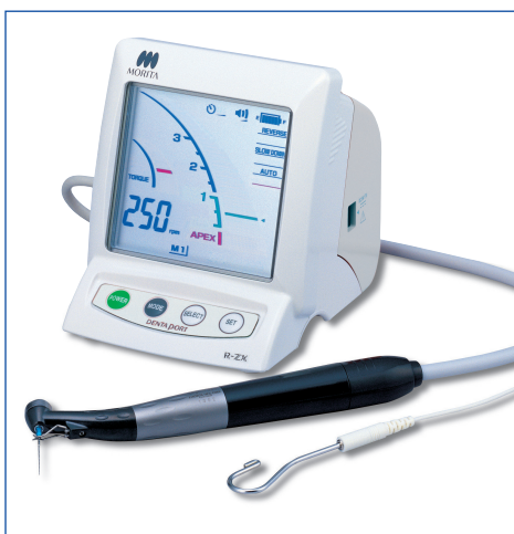
Abb. 1: Das Endomodul-System Dentaport ZX ermöglicht gleichzeitig die Kanalaufbereitung und die endometrische Messung
