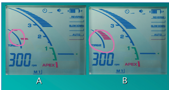
Abb. 3: Bild A: Die lilafarbene Markierung zeigt: Hier wurde für die Drehmomentbegrenzung ein kleiner Wert eingegeben Bild B: Die lilafarbene Markierung liegt weit unten – dies entspricht dem absoluten maximalen Drehmoment von 4,9 Ncm. Wird der voreingestellte Wert erreicht, stoppt oder dreht die Feile automatisch zurück
